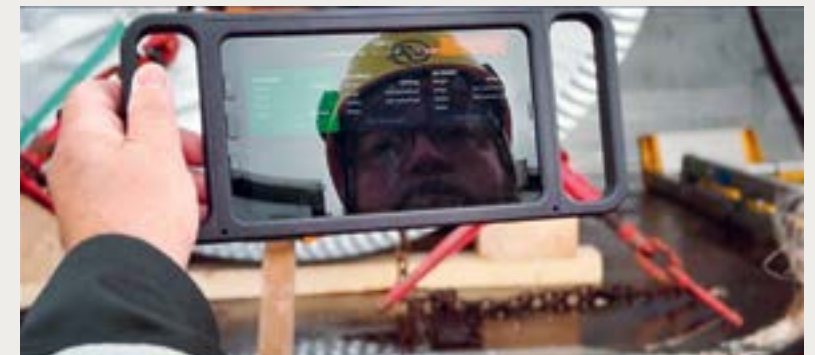
2. Den surrade lasten fotograferas och en AI-kameralösning avgör om lasten är korrekt säkrad.
